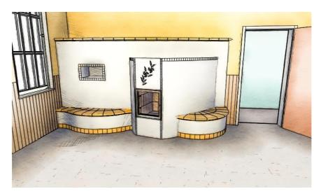
Er gibt seine Wärmeleistung in Form von Strahlungswärme, eine allergikerfreundliche, angenehme und im ganzen Raum gleichmäßig verteilte Wärme, ab. Zusätzlich versorgt er den Flur mit warmer Luft durch einen eingebauten Konvektionsraum.
